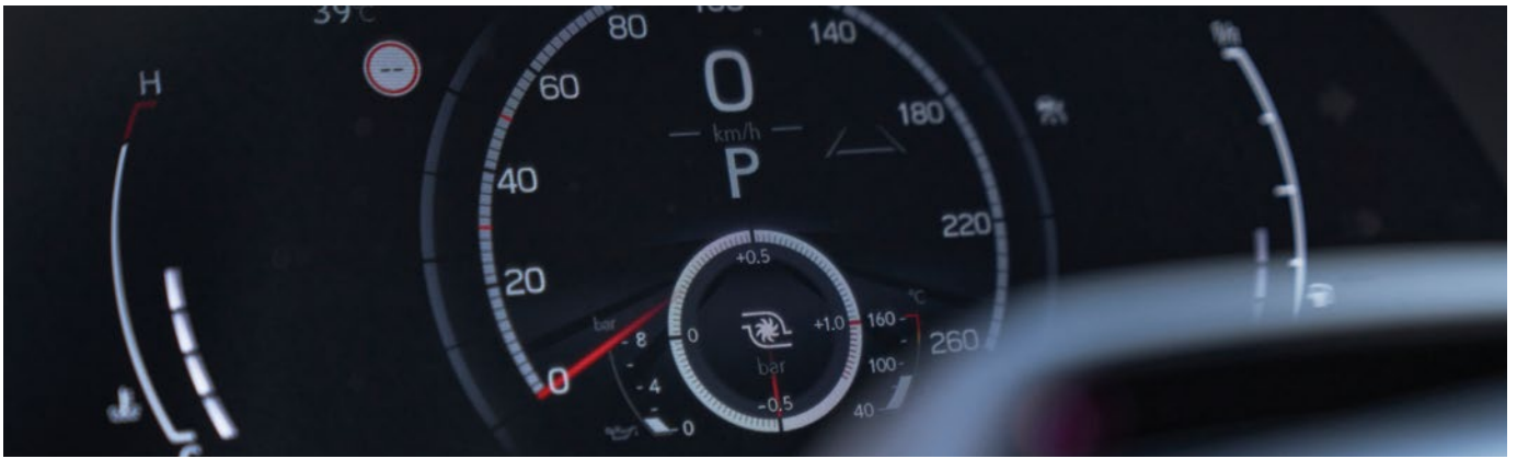
Ovaj TFT (eng. Thin Film Transistor) zaslon sadrži glavne instrumente za vožnju i na njemu se prikazuju sve informacije koje su vam potrebne zajedno sa sigurnosnim upozorenjima
